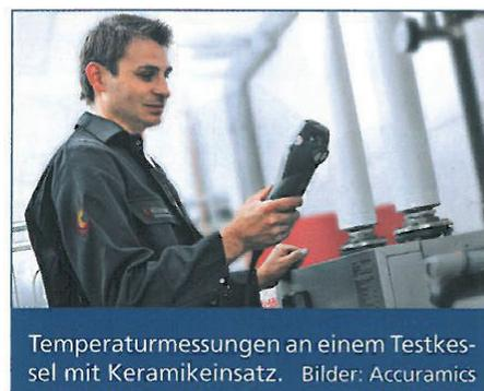
Temperaturmessungen an einem Testkessel mit Keramikeinsatz. Bilder: Accuramics
